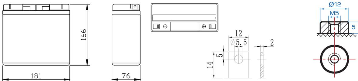
F13 (Schraubanschluss M5)
