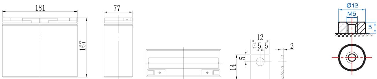
F13 (Schraubanschluss M5)
