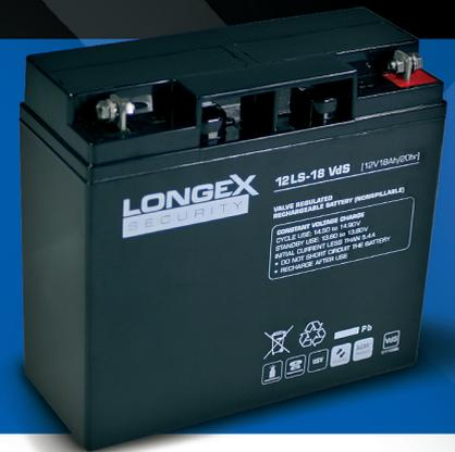
Bei dem **Longex Security Akku 12LS-18** handelt es sich um einen AGM Akku (Blei-Vlies) mit VdS-Zulassung, der speziell für Stand-By-Anwendungen, wie z.B. in der Sicherheitstechnik, Brandmeldetechnik oder USV und UPS, entwickelt wurde.
